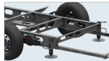
Einbaubeispiel Pumpe aussen. Hier empfehlen wir die optionale Aggregatabdeckung.
